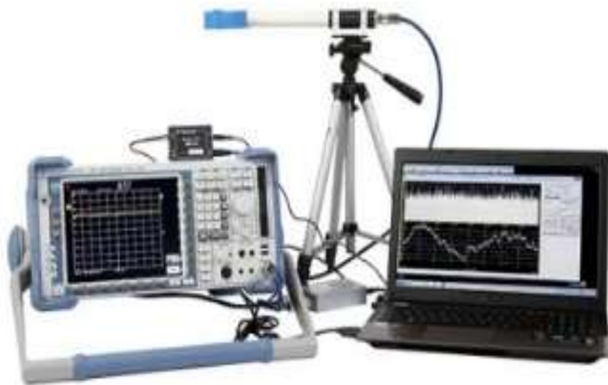
Система оценки защищённости технических средств от утечки информации по каналу ПЭМИН «Сигурд-М8Р»
